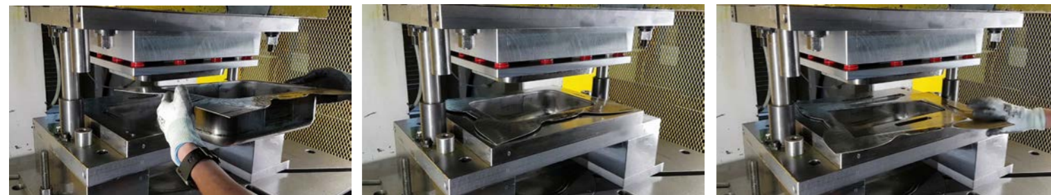
3/ Détourage avant l'opération finale de poinçonnage
